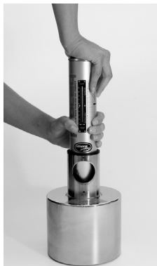
Fig. 3.1 Funktionskontrolle des Betonprüfhammers (Modell N/L abgebildet)
