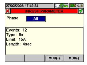
Fig. 107: Inrush current parameters
