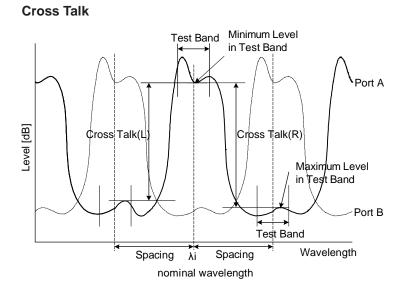
Parameter SPACING TEST BAND
